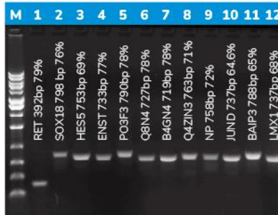
從人類gDNA中12個高CG含量的基因, DNA與DMSO最終濃度為1 ng/μl 與 10%
